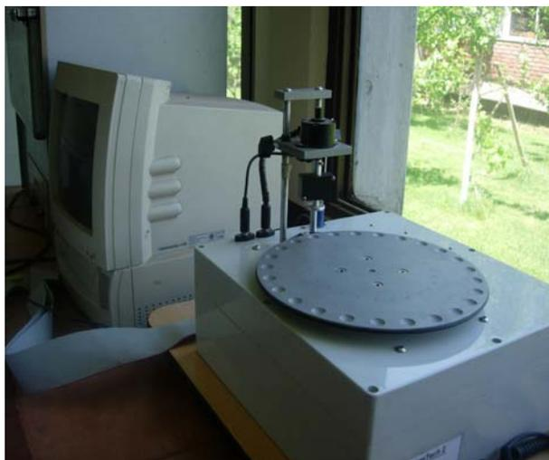
Figura 1. Medidor de firmeza de baya Firmtech2®.
