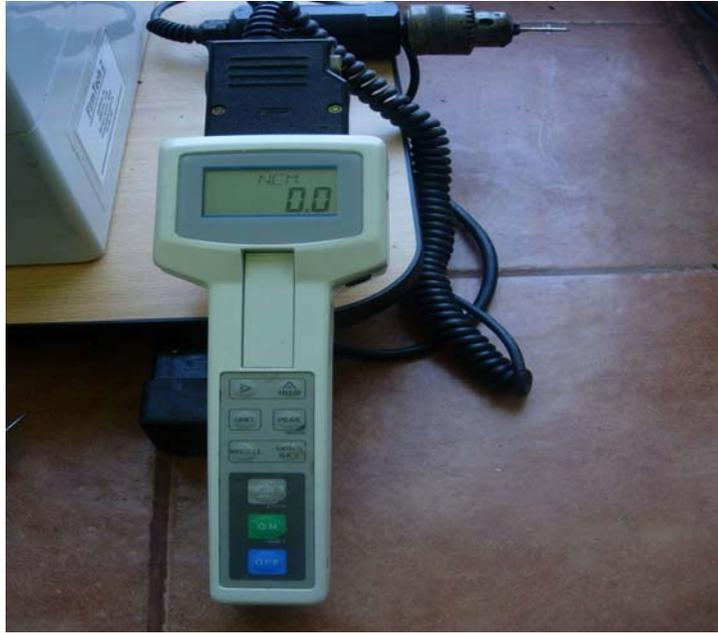
Figura 2. Medidor de firmeza de pulpa Torque Load Sensor®.
