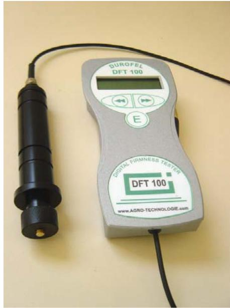
Figura 4. Medidor de firmeza de baya Durofel®.
