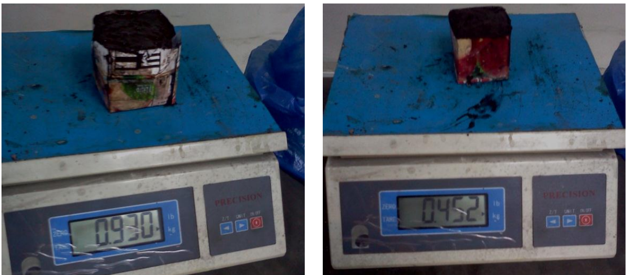
Figura 4.12: Probetas para ensayos de secado pasta/borras de Pb.
