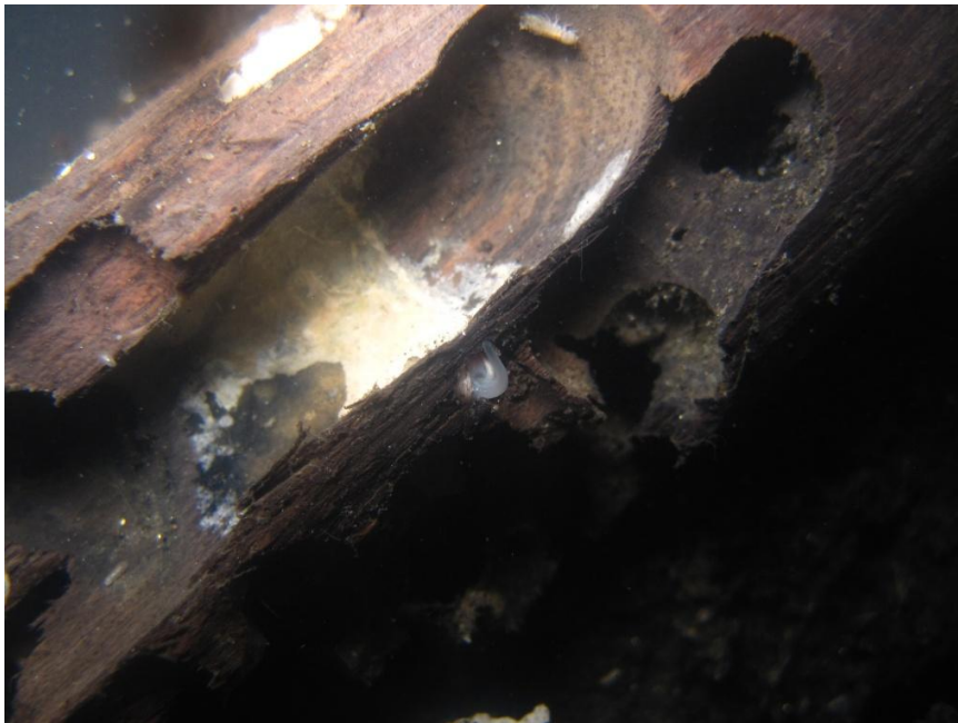
Figura N°24. Detalle del ataque del Xylophaga, se resalta la forma circular de las cavidades. en la parte superior se puede apreciar un pequeño Limnoria. (Foto gentileza de Luis Amaro).
