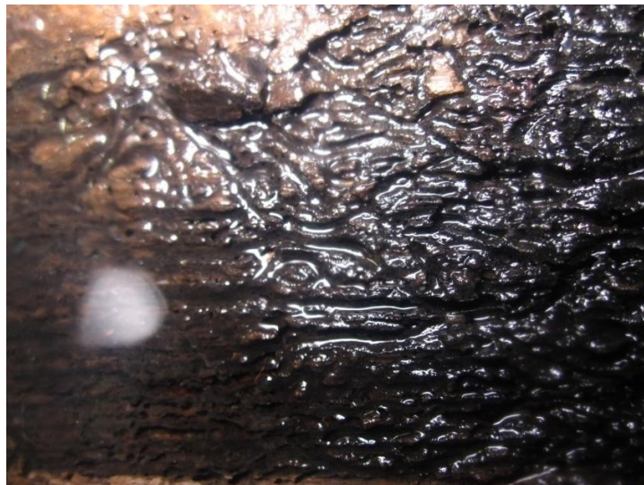
Figura N°26. Ataque del Limnoria , muestra de laboratorio extraída de los restos dispersos del sitio S3PV (Foto gentileza de Luis Amaro).
