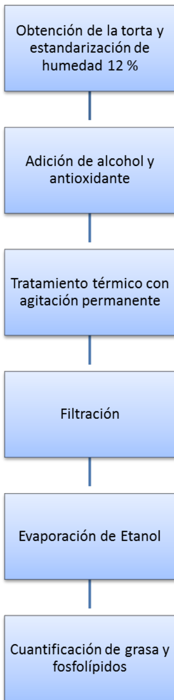
Figura 9: Flujograma del proceso de obtención material lipídico rico en fosfolípidos Omega-3, por medio de la técnica de Etanol.
