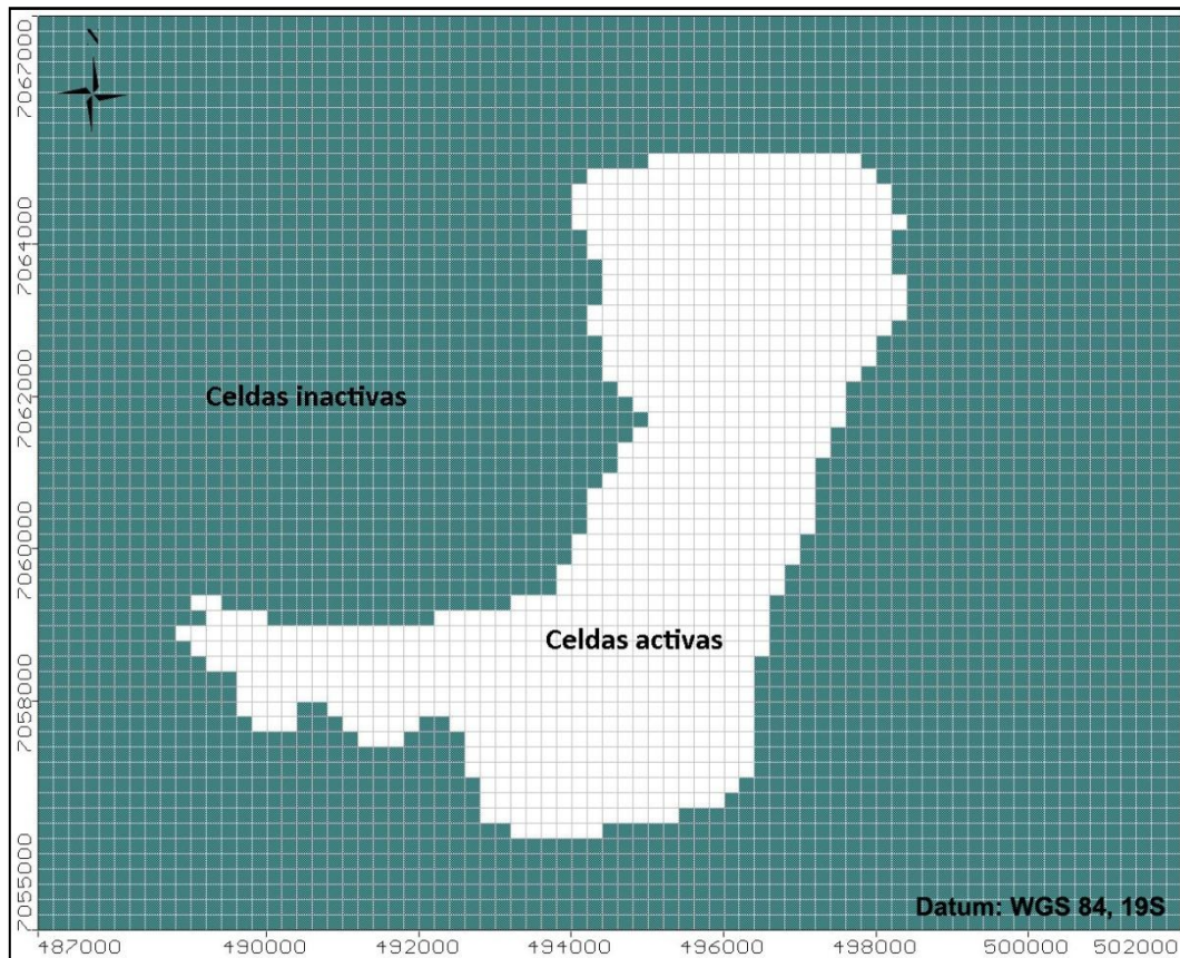
Figura 5.1. Mapa del área modelada generada en Visual Modflow 2011. Se observan las celdas activas en color blanco que simulan el acuífero y las inactivas en color verde.
