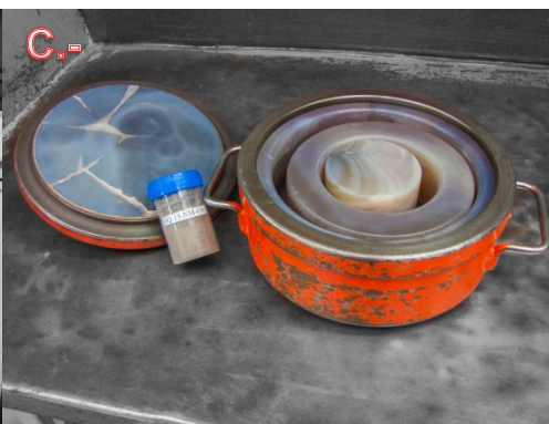
Figura 2-1: Proceso de preparación de muestras. A.- Cuarteado de muestras: la cubeta con la etiqueta se vacía para ser separada en 2 submuestras, una de ellas es guardada como respaldo. B.- Tamizado: la muestra se separa por tamaño granulométrico, buscando obtener la fracción <180 \mu\text{m} . C.- Pulverizado: La fracción fina se pulveriza en mortero de ágata y el material obtenido se vierte en el envase plástico, finalizando la etapa de preparación de muestra. Capturas realizadas en Laboratorio de SERNAGEOMIN.
