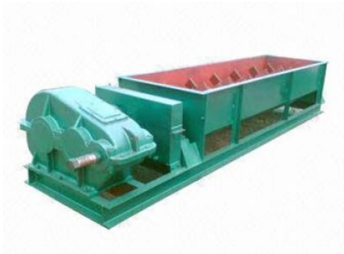
Figura 4.13: Esquema Mezclador de doble eje para sólidos
