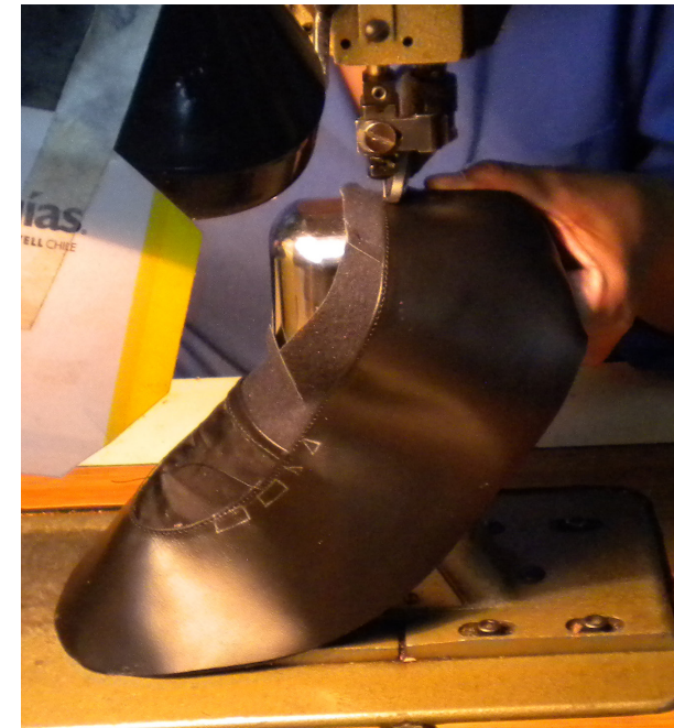
Proceso de aparado. Fuente: Elaboración propia.
