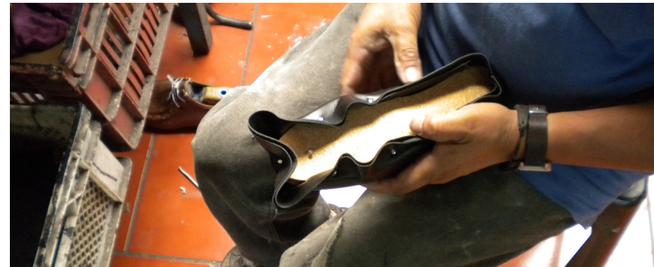
Armado sobre horma. Fuente: Elaboración propia.
