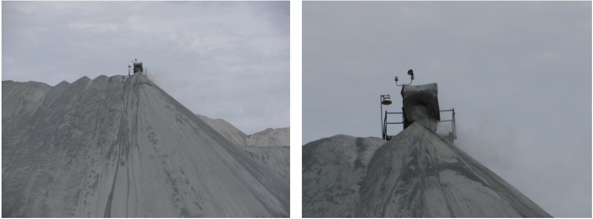
Figura 13. Correa Transportadora en Acopio de Mineral (Fuente: elaboración propia)
