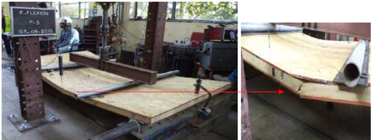
Figura A5.6: Falla ensayo flexión, probeta N°3
