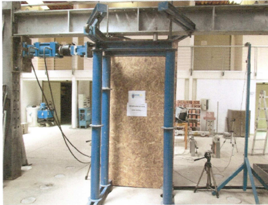
Figura A5.1: Implementación del ensayo de carga horizontal
