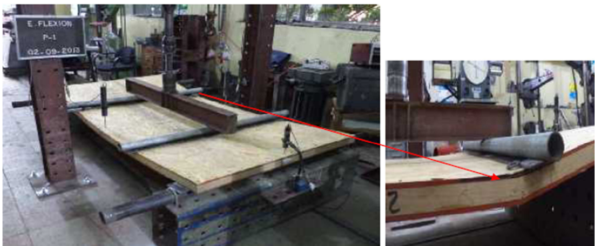
Figura A5.4: Falla ensayo flexión, probeta N°1
