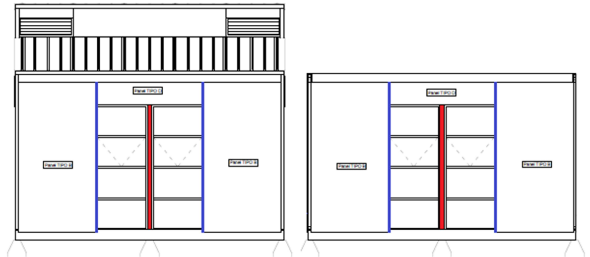
Figura 3.44: Elementos que se recomienda reemplazar, los pies-derechos de color azul por unos de 45x65mm y el pilar de color rojo por uno de 64x64mm, fachada eje "X".
