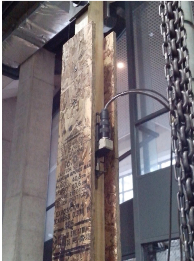
Figura 3.16: Potenciómetro en probeta montada en máquina universal INSTRON
