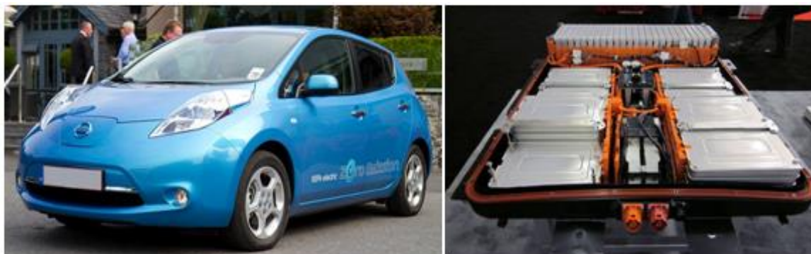
Figura 5-2: Nissan leaf (a la izquierda) y su banco de baterías (a la derecha) [20][13].
