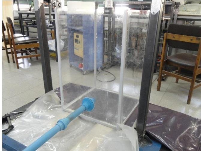
Figura 3-10: Estanque y tubería de succión.
