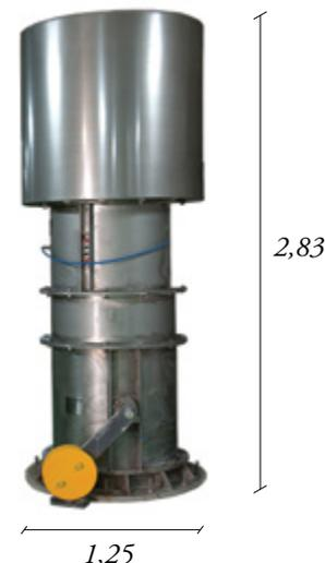
Fig 30. Turbina Wells - Central Undimotriz de Motrico
