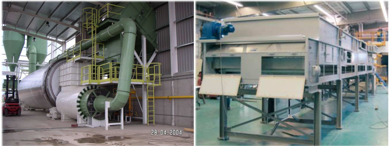
Figura 4.3. Secadores industriales de aserrín. A la derecha aparece el secador tipo trómel y a la izquierda el secador de bandas [75,77] .
