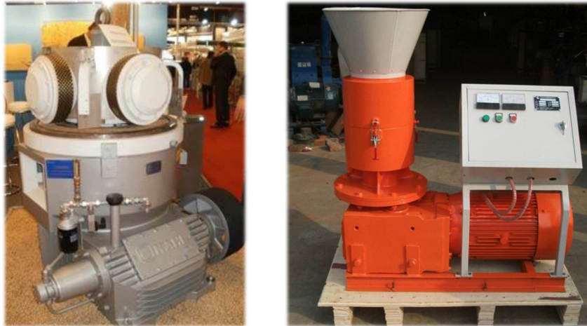
Figura 4.5. Prensas de peletizado de residuos madereros. A la izquierda aparece una prensa de matriz plana, mientras que a la izquierda una de matriz anular [75,77] .
