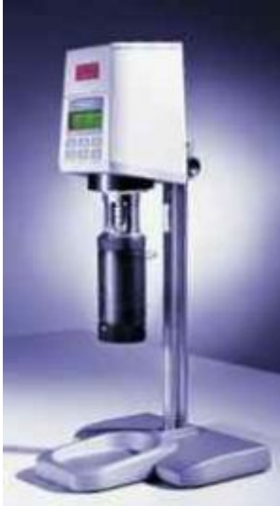
Figura 3.2: Reómetro utilizado en la determinación de la reología de los fluidos.
