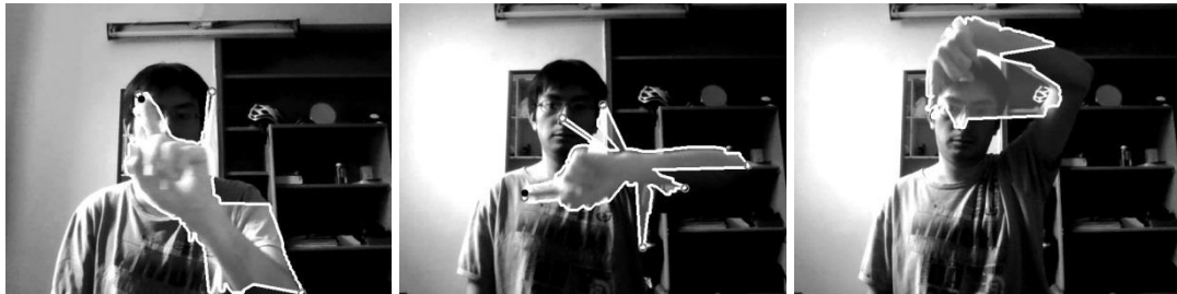
Ilustración 72: Contornos y puntos característicos en poses (izq.) cómoda, (cen.) incómoda y (der.) muy incómoda.
