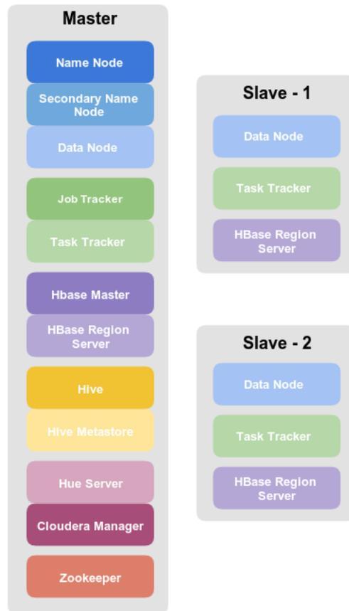
Figura 4.4: Roles de las máquinas
