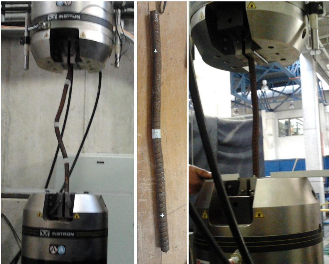
Figura 27: Estirado de probetas con pandeo.
