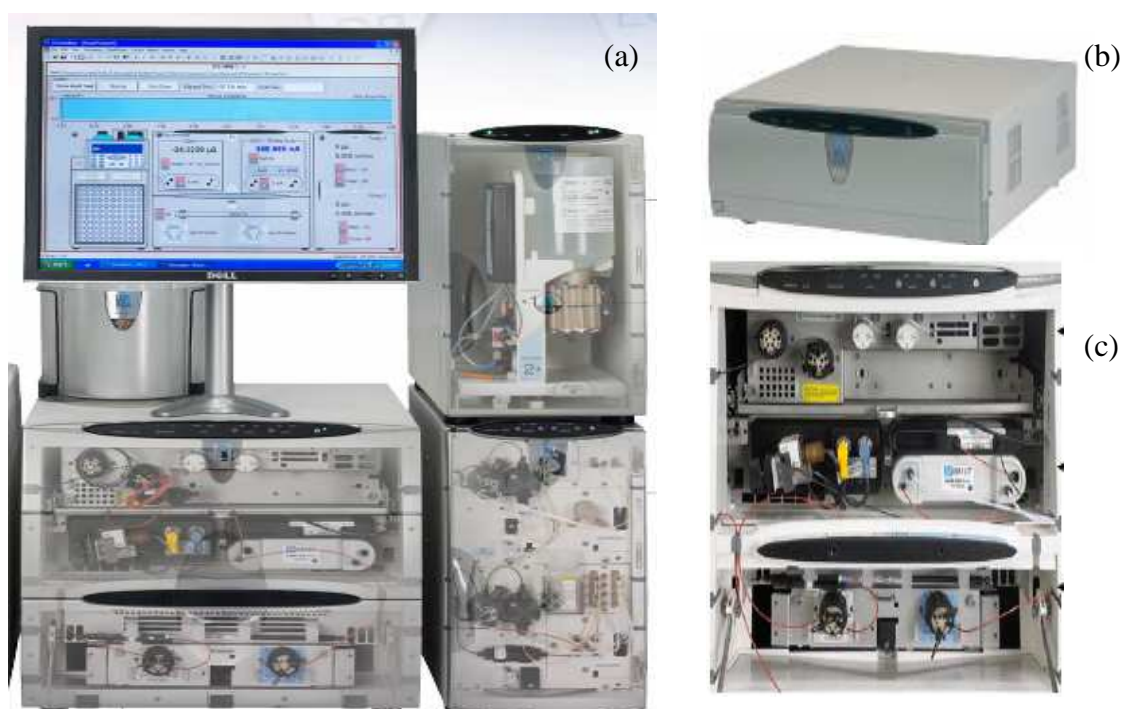
Figura 4.- (a) cromatógrafo iónico utilizado, (b) autosampler, (c) columna, detector y supresor.
