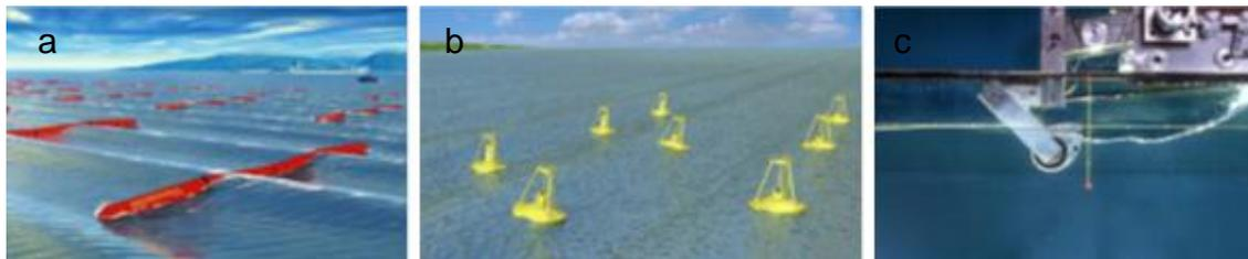
ILUSTRACIÓN 5: TECNOLOGÍAS EXISTENTES EN LA ACTUALIDAD DIFERENCIADAS POR MODO DE FUNCIONAMIENTO. A) ATENUADOR; B) ABSORBEDOR; C) TERMINADOR.
