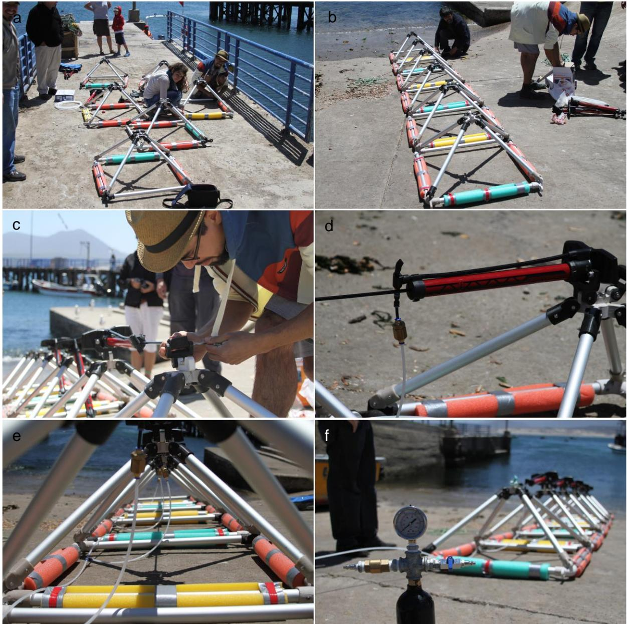
**ILUSTRACIÓN 65: ETAPAS DE ENSAMBLAJE DEL SISTEMA NAHUENREW. A) SE ARMA CADA PIRÁMIDE, B) SE UNEN LAS PIRÁMIDES, C) SE INSTALAN LAS PIEZAS QUE SUJETAN LOS BOMBINES Y LOS BOMBINES, D) SE INSTALAN LOS NIPLES, VÁLVULAS Y MANGUERAS, E) SE UNEN TODAS LAS MANGUERAS, F) SE CONECTA LA MANGUERA PRINCIPAL CON EL TANQUE.**
