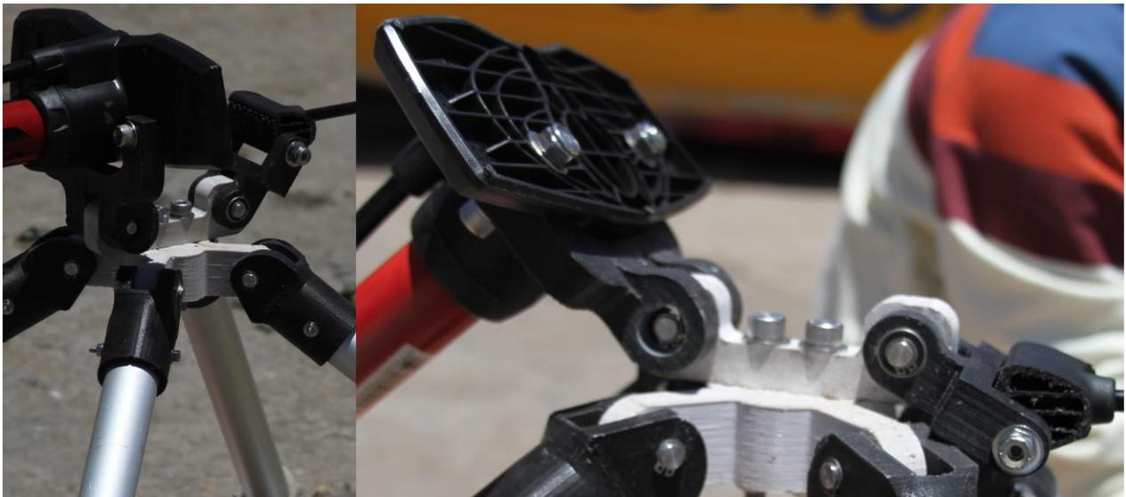
ILUSTRACIÓN 57: ACOPLÉ ENTRE BOMBINES Y ESTRUCTURA.
