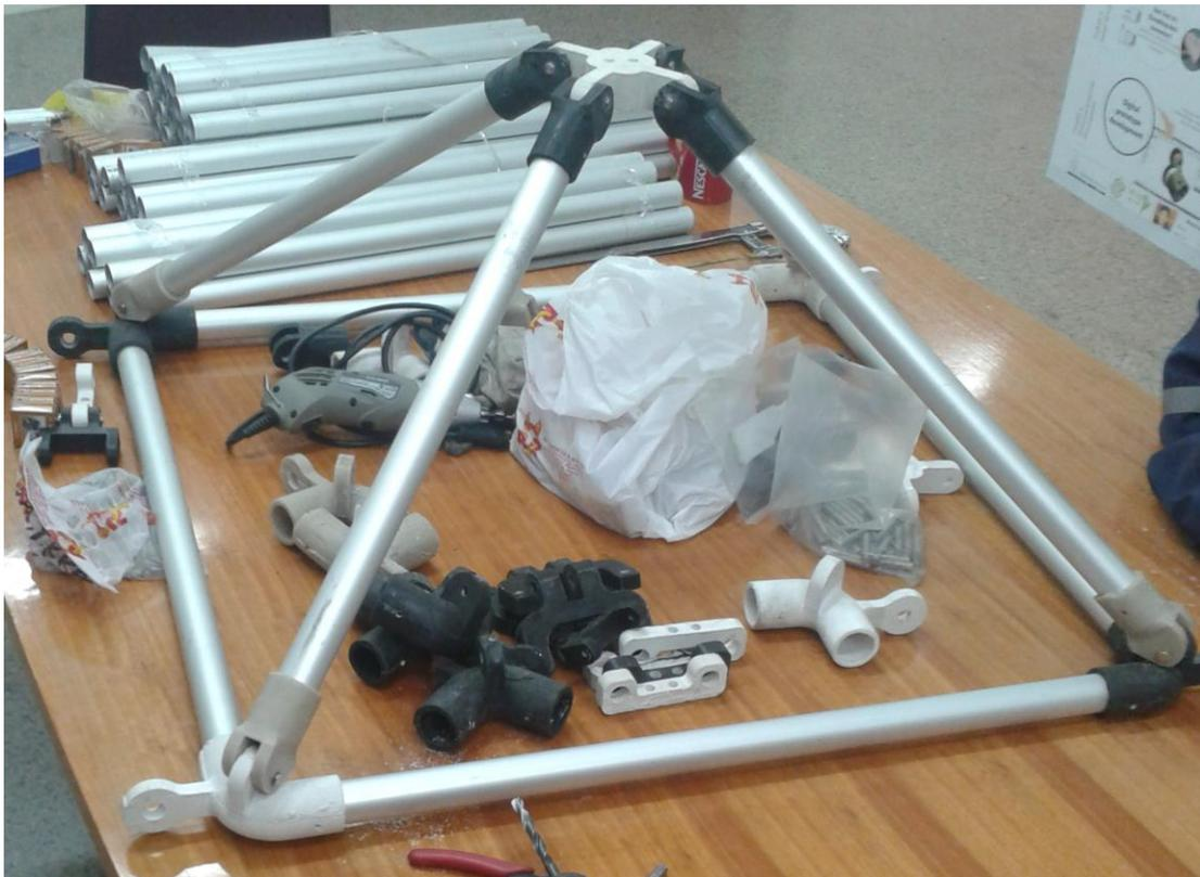
**ILUSTRACIÓN 53: PRIMERA PIRÁMIDE ARMADA, LAS PIEZAS QUEDARON CON LAS DIMENSIONES Y AJUSTES REQUERIDOS.**
