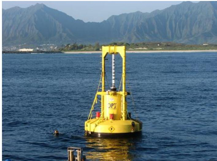
ILUSTRACIÓN 8: POWERBUOY FUNCIONANDO EN EL MAR.
