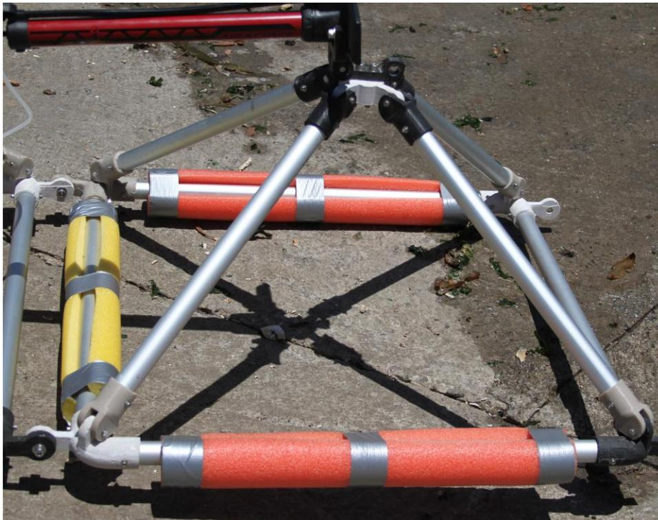
**ILUSTRACIÓN 56: ESTRUCTURA PIRÁMIDE COMPLETAMENTE ARMADA, CON FLOTADORES Y ACTUADOR.**
