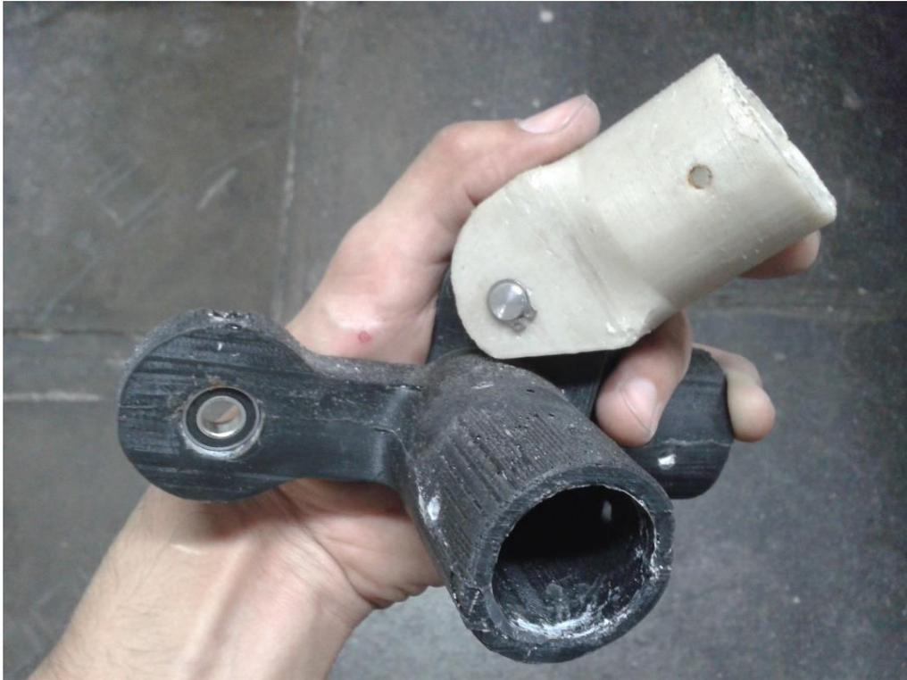
**ILUSTRACIÓN 50: CODO DE TRES EJES, DOS FIJOS SEPARADOS EN 90° Y UN TERCERO QUE PUEDE ROTAR.**
