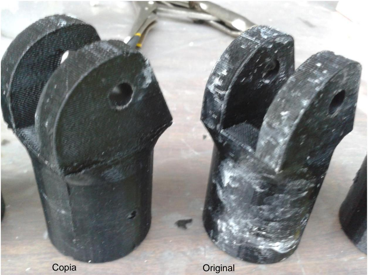
**ILUSTRACIÓN 37: PIEZA OBTENIDA CON VACIADO DE RESINA EN MOLDES DE SILICONA DE CAUCHO.**
