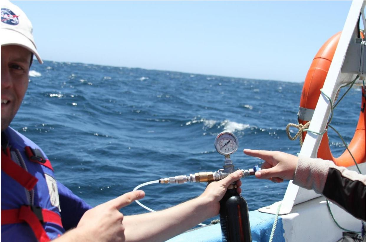
**ILUSTRACIÓN 74: SISTEMA NAHUEENREW LOGRA SUBIR LA PRESIÓN DEL ESTANQUE HASTA 4[PSI].**
