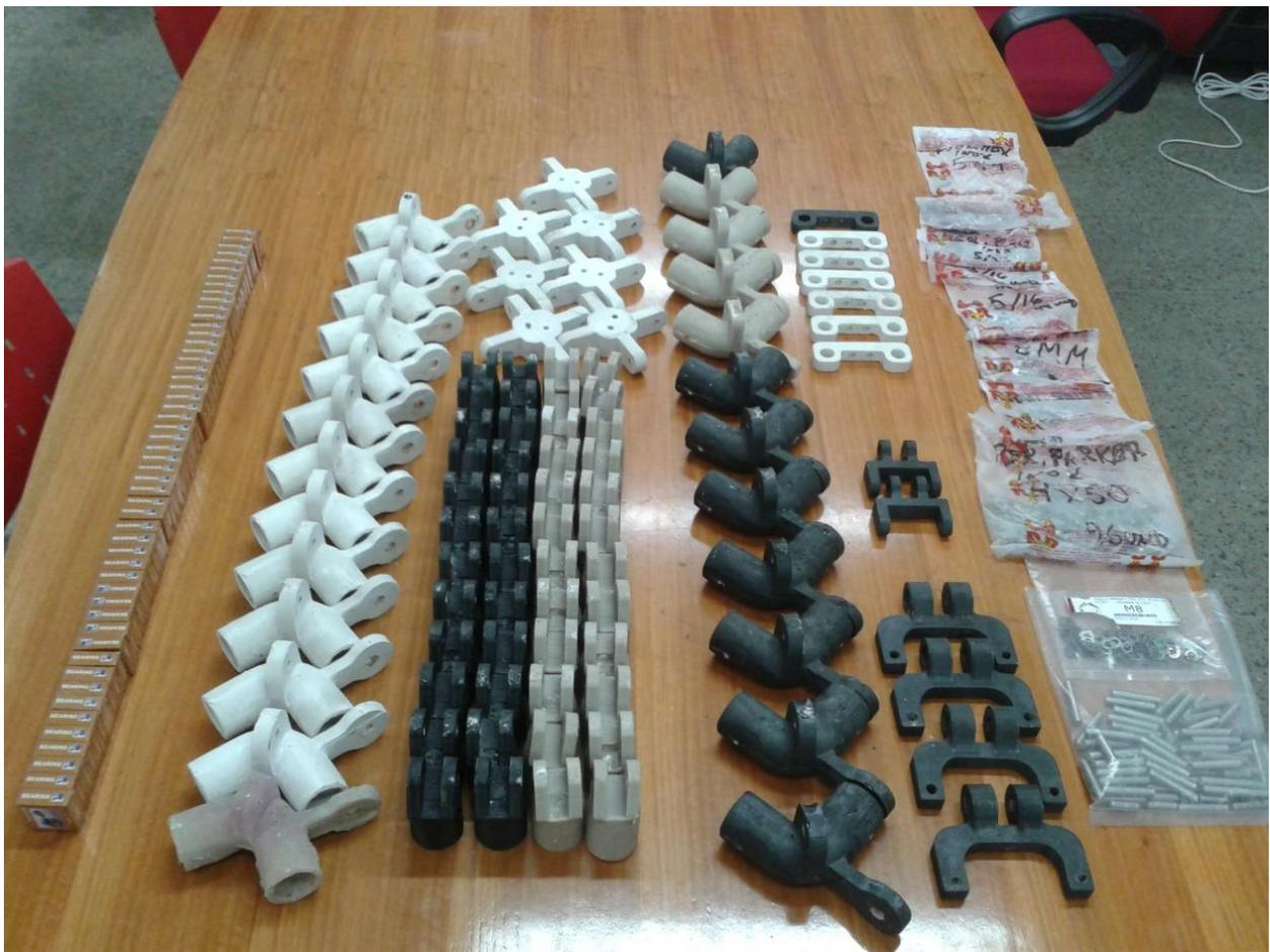
**ILUSTRACIÓN 43: CONJUNTO TOTAL DE PIEZAS CONSTRUIDAS POR VACIADO DE RESINA MÁS OTROS ELEMENTOS QUE CONSTITUYEN EL SISTEMA UNDÍVAGO.**
