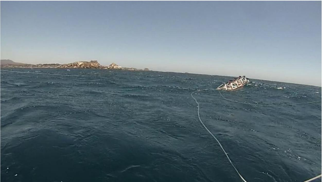
**ILUSTRACIÓN 73: NAHUENREW SALIENDO DE UN VALLE DE OLA CUYA LONGITUD DE ONDA ES MUCHO MAYOR AL LARGO DE LA ESTRUCTURA.**
