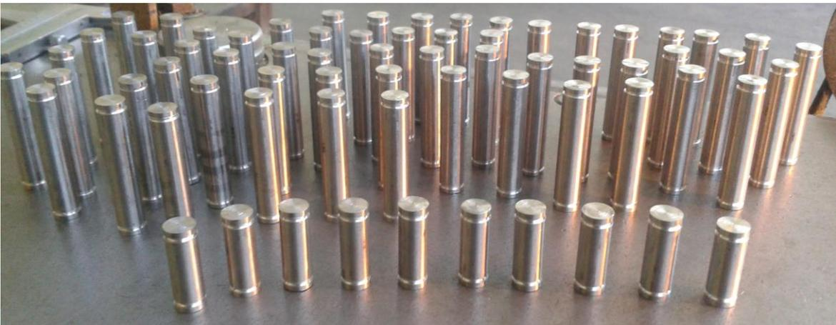
**ILUSTRACIÓN 49: EJES DE ACERO INOXIDABLE MAQUINADOS EN EL TORNO.**
