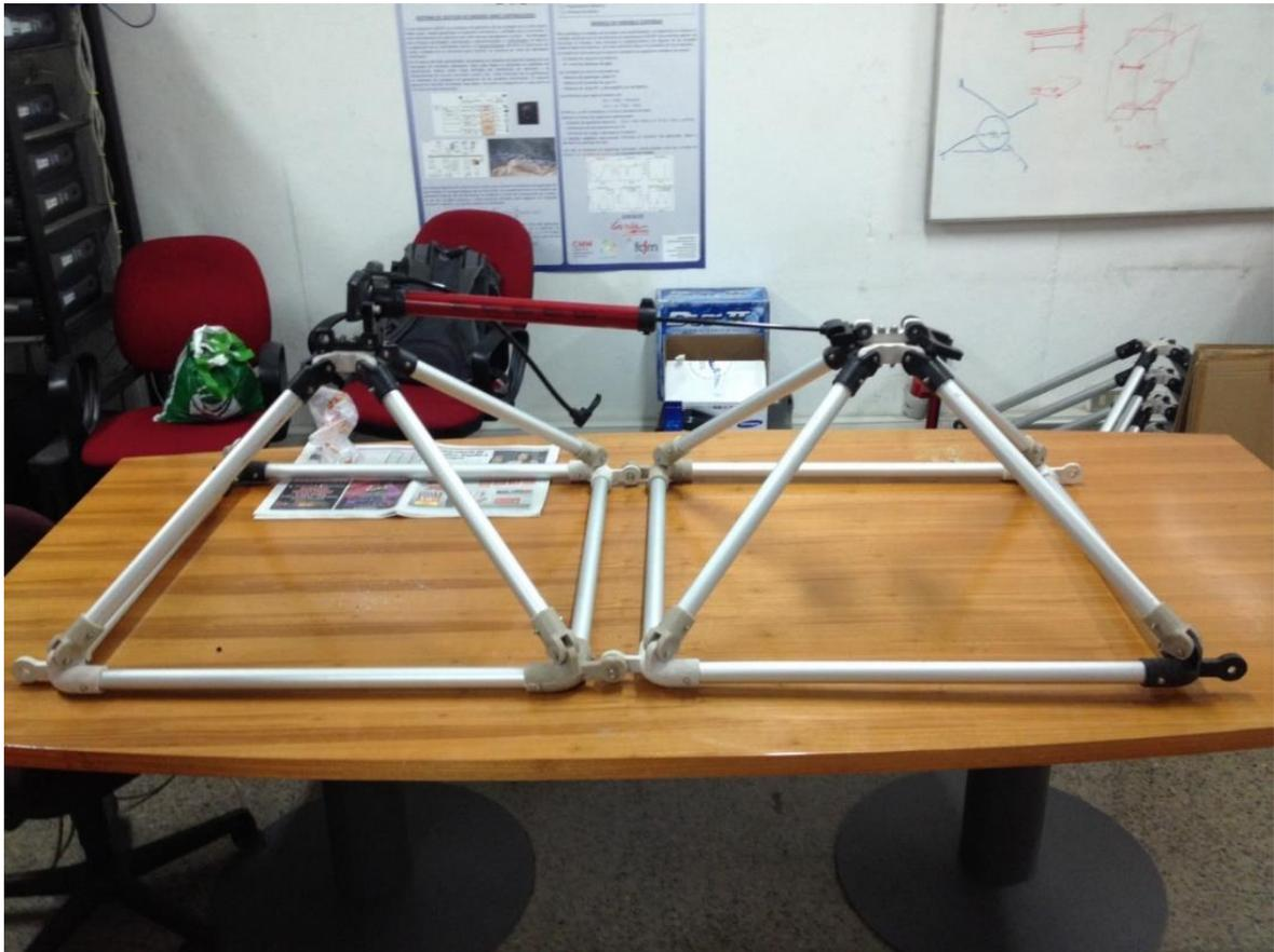
**ILUSTRACIÓN 54: PRIMERA PRUEBA DE ENSAMBLAJE ENTRE PIRÁMIDES. MONTAJE DE ACTUADOR (BOMBÍN) SIN COMPLICACIONES.**
