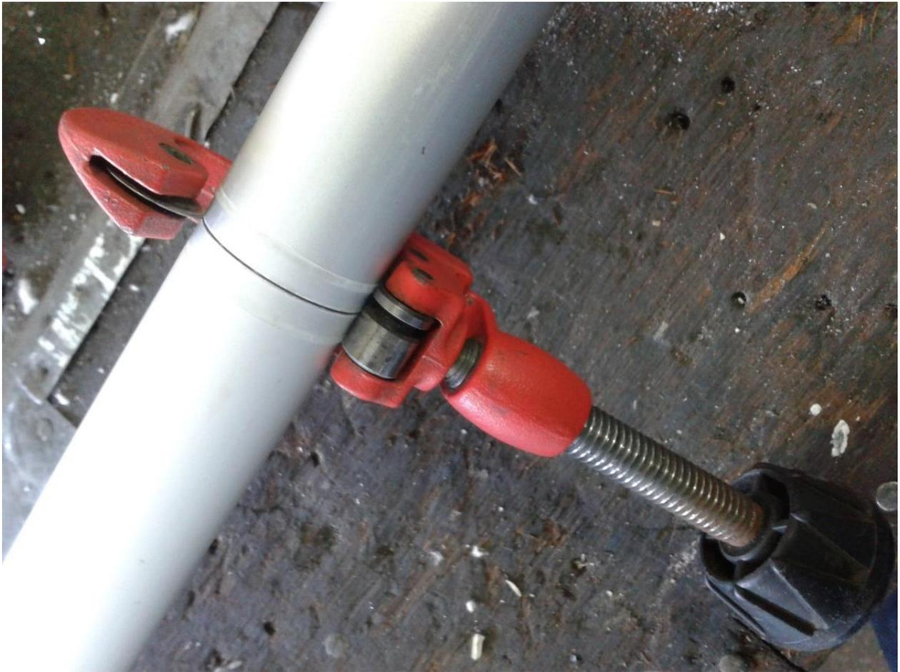
**ILUSTRACIÓN 45: HERRAMIENTA DE CORTE PARA TUBOS DE MATERIAL BLANDO COMO ALUMINIO.**
