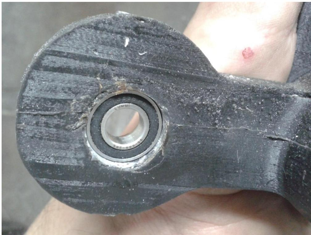
**ILUSTRACIÓN 51: RODAMIENTO INOXIDABLE EN LA UNIÓN ENTRE PIRÁMIDES.**
