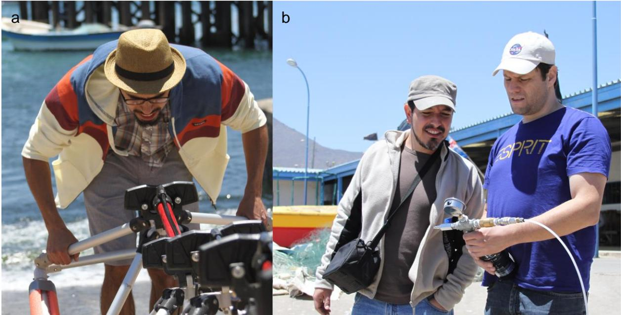
**ILUSTRACIÓN 66: IMAGEN IZQUIERDA: GUSTAVO DÍAZ CORROBORA QUE LAS PIRÁMIDES SE ARTICULAN BIEN. IMAGEN DERECHA: EDUARDO GONZÁLEZ Y JUAN CRISTÓBAL ZAGAL CORROBORAN QUE AUMENTA LA PRESIÓN EN EL TANQUE Y QUE NO HAY FUGAS DE AIRE.**
