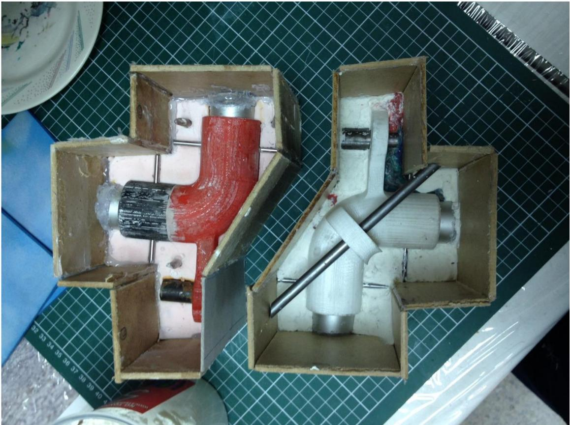
**ILUSTRACIÓN 34: PREPARACIÓN DE MOLDES EN SILICONA DE CAUCHO CON CARRILES DE ACERO Y ALUMINIO.**
