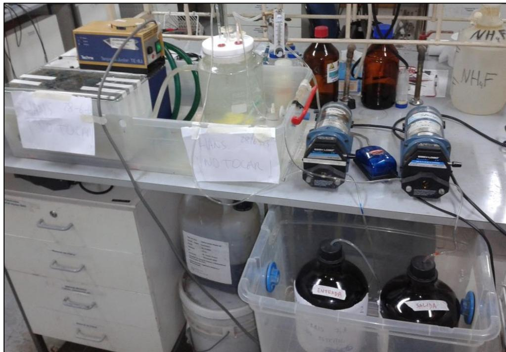
**Figura 9:** Montaje experimental del biorreactor en modo continuo de operación. Se utiliza el mismo diseño que en batch, agregando sistemas de entrada de medio de cultivo y salida de la solución ácida producida en el biorreactor.
