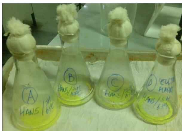
Figura 11: Imagen de los 4 matraces utilizados para la preparación de inóculos de *Sulfolobus metallicus* sobre azufre elemental a 67 °C.
