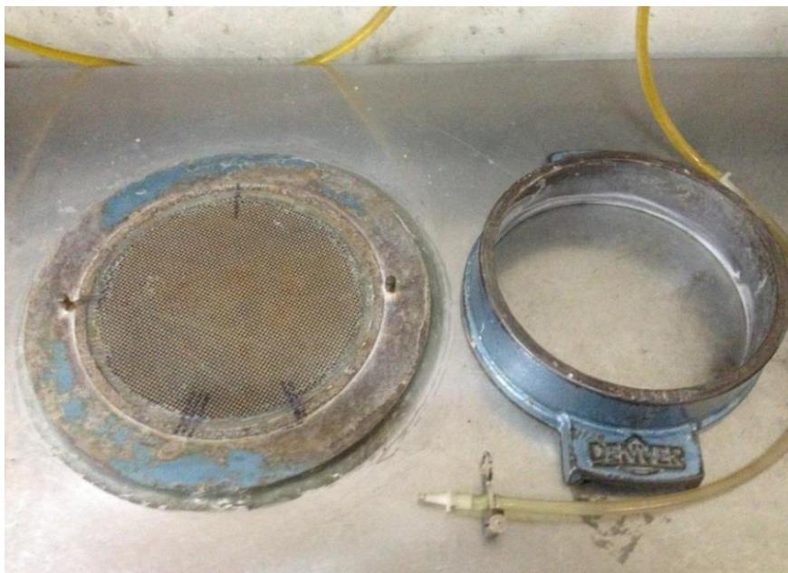
Figura 6: Toma de aire del sistema de filtración y estructura contenedora
