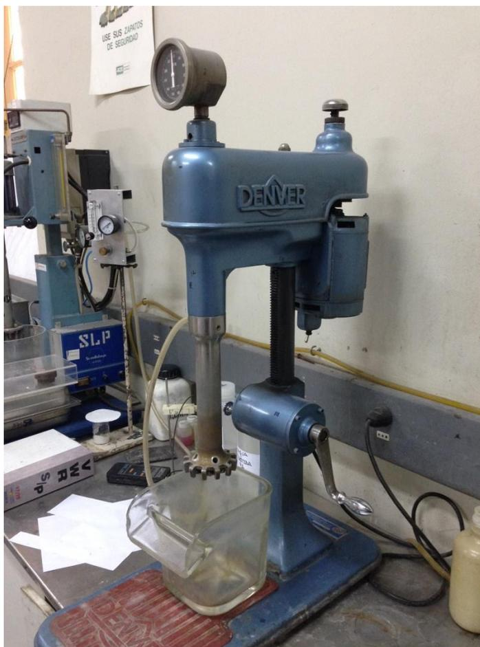
Figura 3: Celda Denver utilizada en las pruebas experimentales
