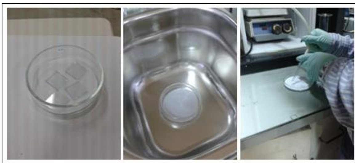
Figura 123: Limpieza con ultrasonido del ITO.
