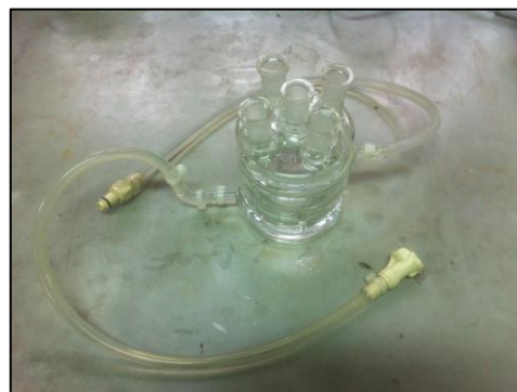
Figura 27: Celda doble camisa y tapa usadas en trabajo experimental.
