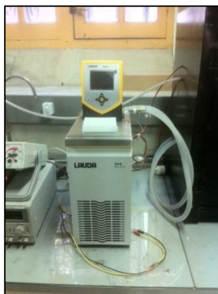
Figura 28: Baño termostatzado, marca Lauda, modelo ECO Re41
