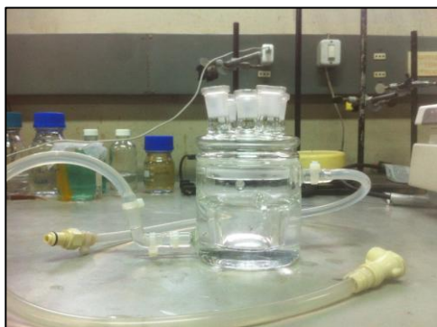
Figura 27: Celda doble camisa y tapa usadas en trabajo experimental.
