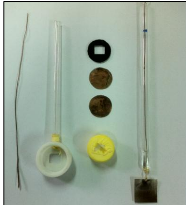
Figura 30: Electrodos utilizados. A la derecha el electrodo e platino. A la izquierda las piezas para el ensamblado del porta electrodo de ITO.
