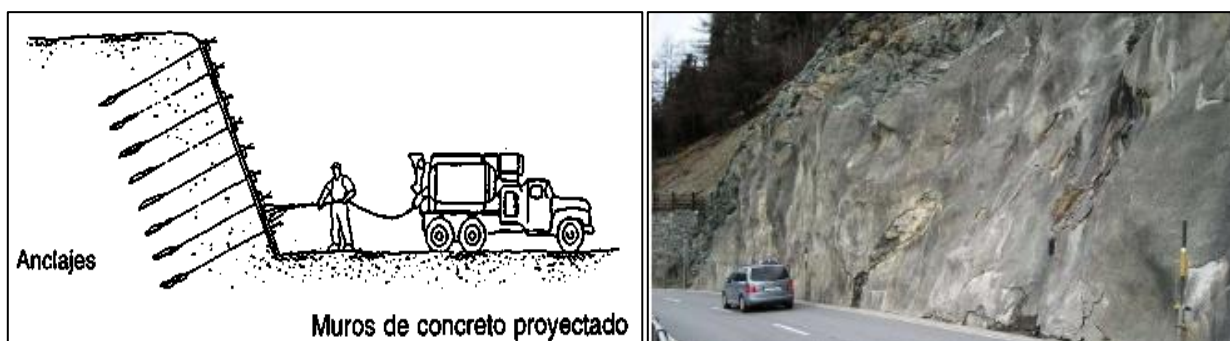
Ilustración 2.6 : Shotcrete y anclajes como medidas de mitigación.
