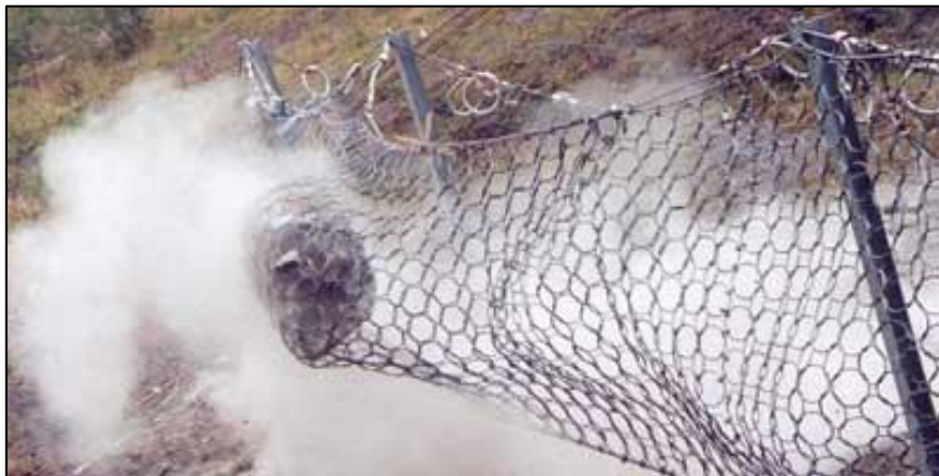
Ilustración 2.9 : Barrera dinámica para mitigación de caídas de roca
