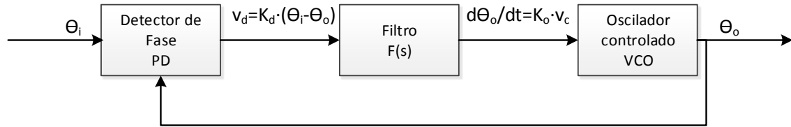
Figura 2-14: Diagrama básico PLL.
