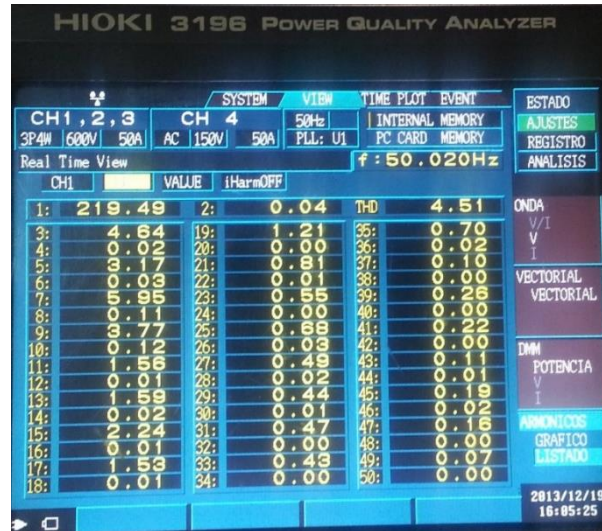
Figura 3-4: Tensión, frecuencia y distorsión armónica durante pruebas de implementación de algoritmos en Central Micro Hidráulica Plug & Play en operación aislada.
