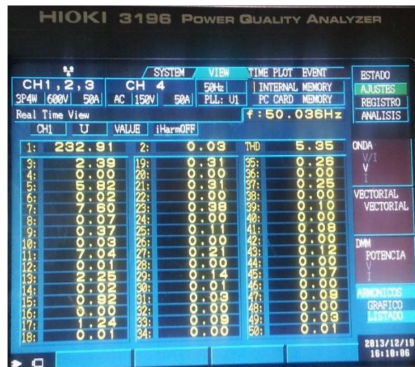
Figura 3-5: Tensión, frecuencia y distorsión armónica durante pruebas de implementación de algoritmos en Central Micro Hidráulica Plug & Play en operación sincronizada a la red.
