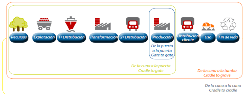
Figura 2-7: Etapas del ciclo de vida a considerar en enfoque B2B o B2C (Ihobe, 2009)
