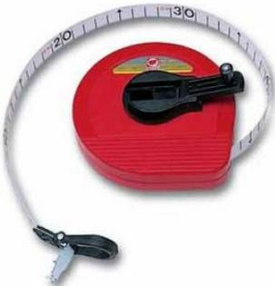
Se utiliza para la medición de perímetros. Debe estar calibrada en centímetros, con graduaciones en milímetros y ser de acero flexible. La cinta debe ser flexible, no extensible de no más de 7 mm de ancho y debe tener un espacio de al menos 3 cm antes de la línea de registro del cero. Si la cinta se ubica en la pared también puede ser utilizada para la medición de estatura.
