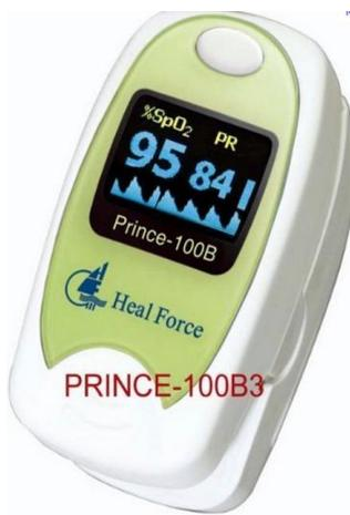
Dispositivo médico utilizado para medir de forma indirecta la saturación de oxígeno de la sangre de un paciente. Mide la absorción de luz de longitudes de onda específicas al pasar por un lecho vascular arterial pulsátil. Además se utiliza para medir la frecuencia cardiaca. Es un instrumento no invasivo y portátil y se utiliza generalmente en un dedo o en el lóbulo de la oreja.
