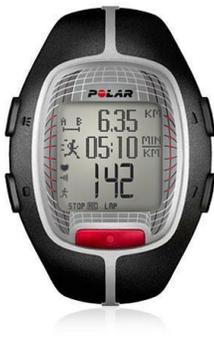
Dispositivo electrónico utilizado para medir frecuencia cardiaca en tiempo real de un individuo durante la realización de una actividad. Consta de dos partes, un reloj receptor que muestra la frecuencia cardiaca durante la actividad, y una banda pectoral transmisora que posee electrodos que al estar en contacto con la piel, captan los latidos del corazón y transmiten la información al reloj receptor.
