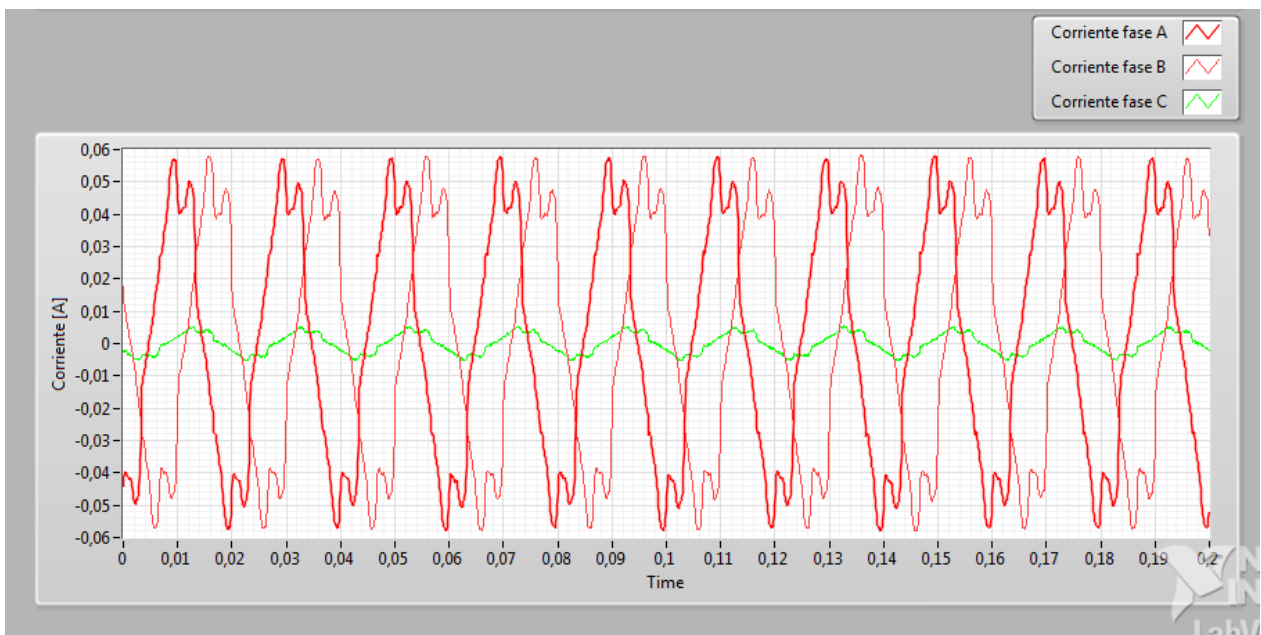
Figura 3.5: Forma de onda de corriente bajo carga de 1,86 A
