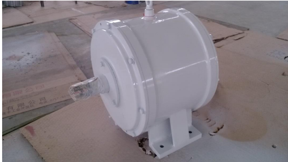
Figura 3.22: Generador sincrónico del banco de pruebas.
