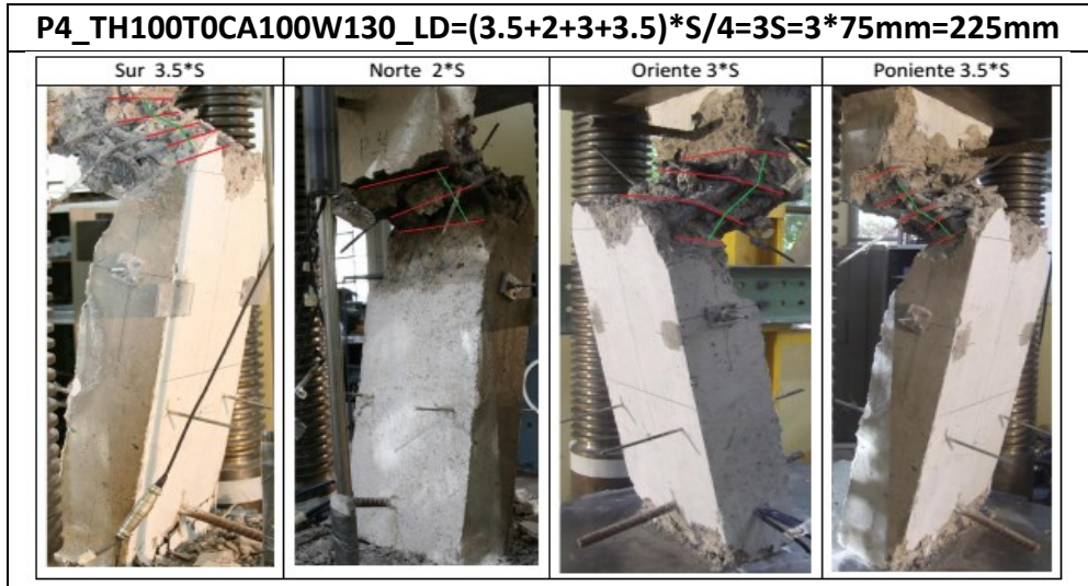
Figura 4.93. Anexo A Mecanismo de falla probeta 4
