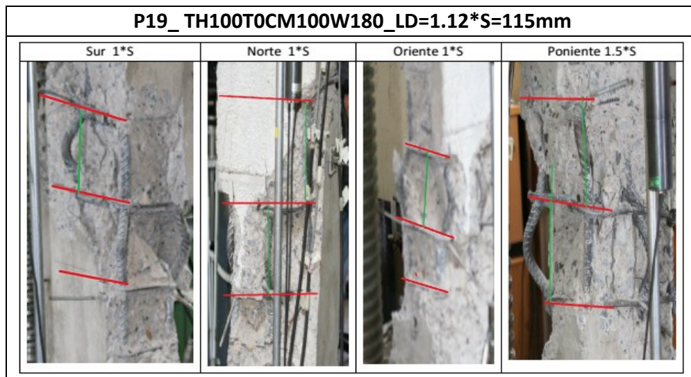
Figura 4.106. Anexo A Mecanismo de falla probeta 19
