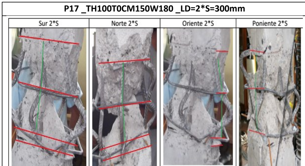
Figura 4.104.Anexo A Mecanismo de falla probeta 17
