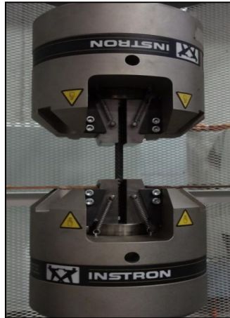
Figura 2.1.Máquina de ensayo a tracción de barras de acero.
