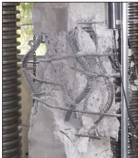
Figura 4.9. Abertura de estribos en probeta P20 con terminación de estribos en 90°
