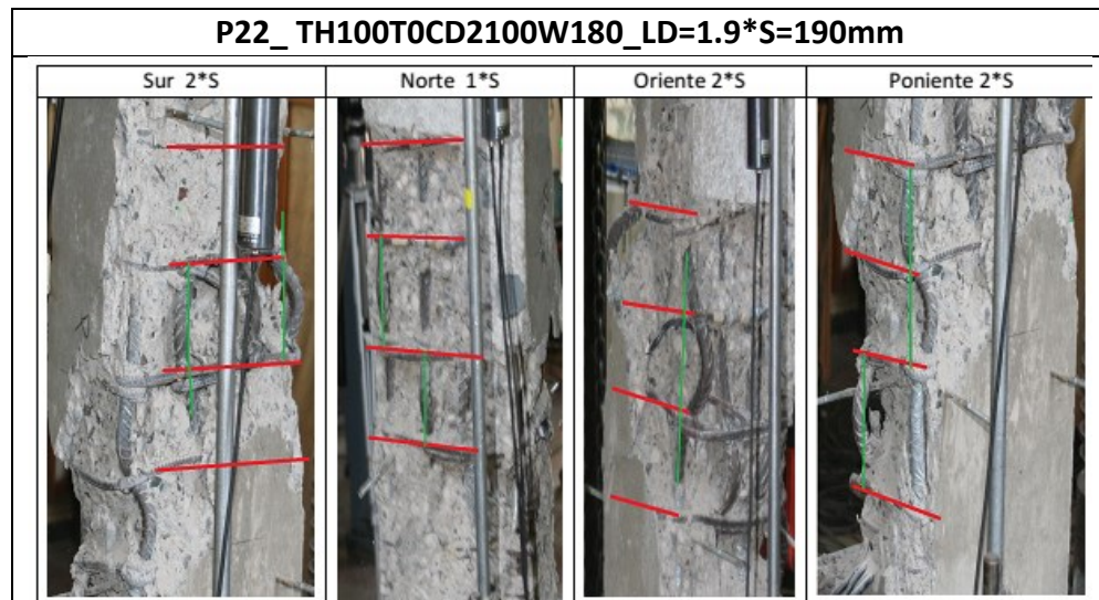
Figura 4.109.Anexo A Mecanismo de falla probeta 22
