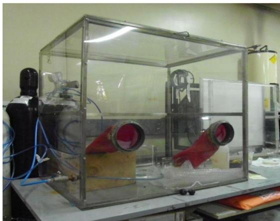
Figura 29: Cámara de lavado y secado de electrodo de pirita.
