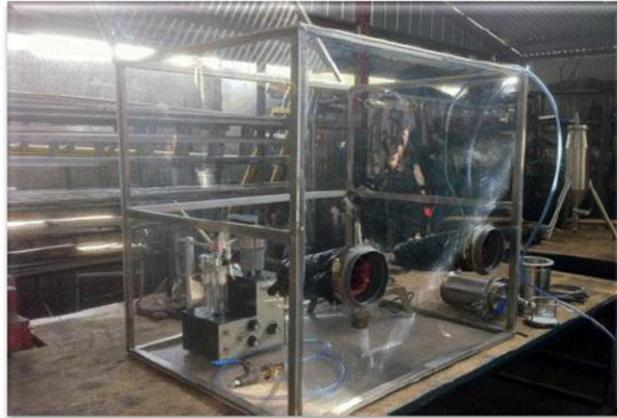
**Figura 33:** Cámara de secado y división de muestras para XPS.
