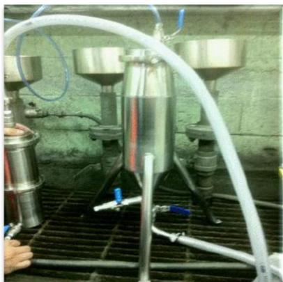
**Figura 31:** Cámara contenedora de agua de lavado para muestras de planta
