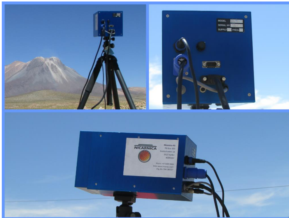
Figura 4.2 Cámara Envicam-2 desde distintos ángulos en una de las campañas a terreno. La cámara está montada en un trípode, los cables conectados a un notebook y a una batería.
