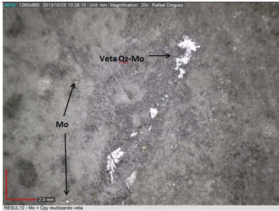
Figura 33. Imagen macroscópica de la muestra RESUL13. Vetilla Qz-Mo y Mo diseminada en la roca.
