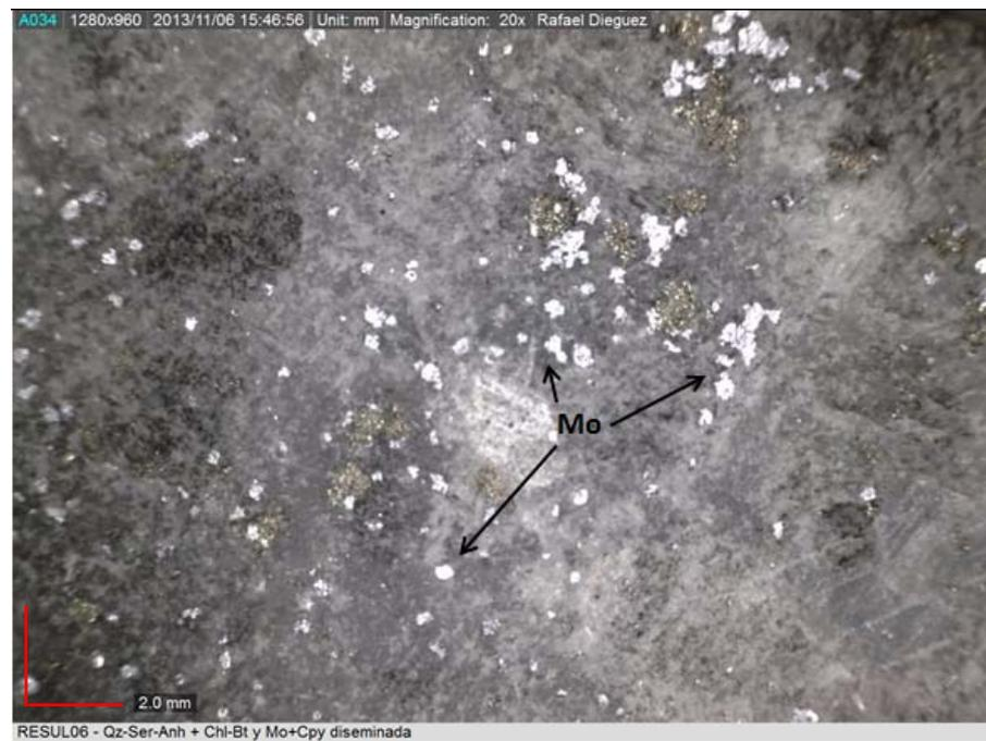
**Figura 28. Imagen macroscópica de muestra RESUL06. Molibdenita diseminada. Mo: molibdenita.**
