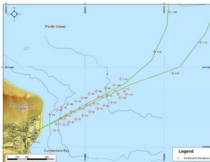
Figura 4.2: Posición de puntos de muestras de sedimentos. Figura obtenida de BENTOS S.A., 2011. Bottom re-survey at IMS hydroacoustic station Hao3, Juan Fernández Islands, Chile, 2011. Estudio batimétrico para la CTBO.
