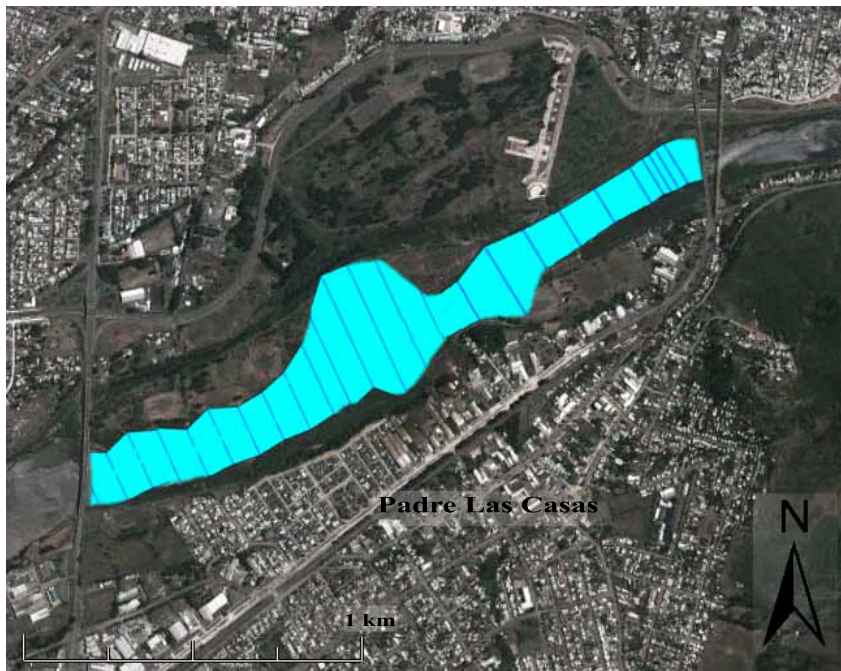
Figura 5.16: Inundación en la zona de estudio para el caudal simulado futuro T=200 del escenario E3S1.
