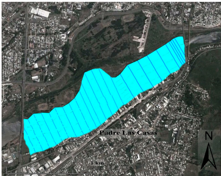
Figura 5.17: Inundación en la zona de estudio para el caudal histórico simulado T=50.
