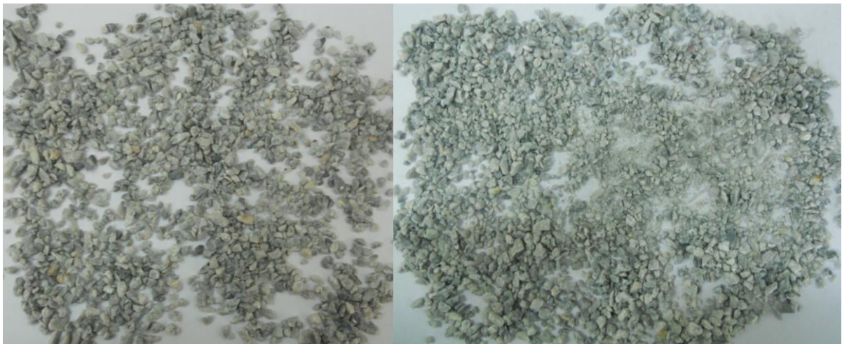
Figura 69: Muestra inicial (izquierda) versus muestra ensayada a 7 \text{ kg/cm}^2 y \text{DR}=100\% (derecha) para el material QMS
