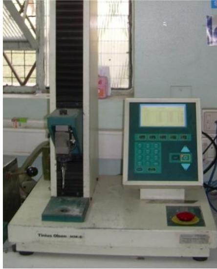
Fig.20: Máquina de tracción universal Tinius Olsen H5K- S
