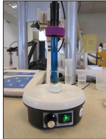
Figura 16 y 17: Ionómetro Oakton Ion 510 Series y medición de fluoruro en muestra salival.
