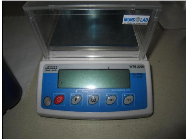
Figura 12: Balanza Radwag WTB 2000 utilizada para medir VFS.
