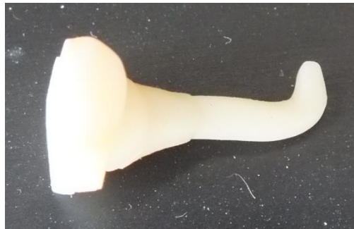
Figura 2: Segmento de tercer molar unido con vástago de resina.
