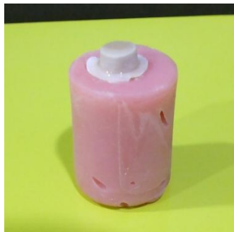
Figura 4: Disco de Alúmina posicionado sobre Esmalte dentina con resina Fluida SDI Wave HV.
