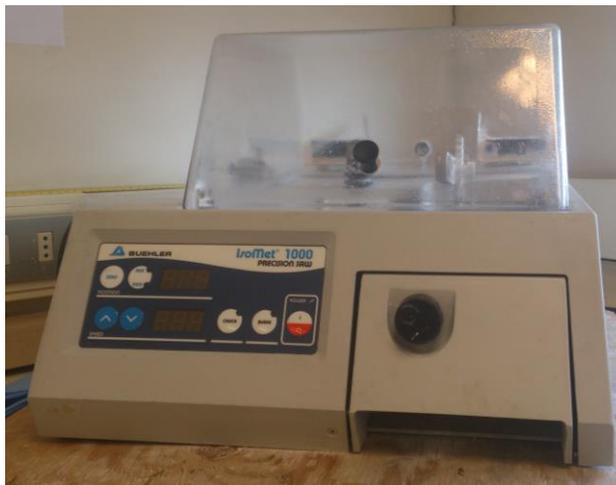
**Fig. 6:** Recortadora Isomet Buehler Ler Lakebuff IL, USA 1000.
