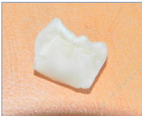
Imagen N° 3: Mitad de pieza dentaria, a ésta superficie se adhirió el cilindro de resina.
