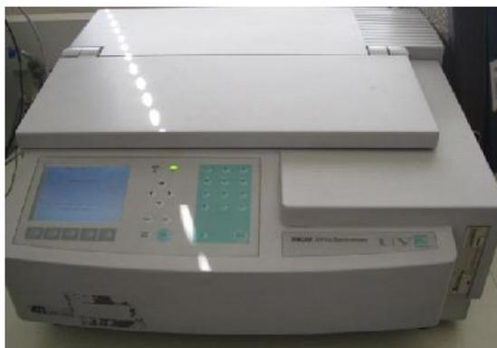
Fig. N° 1 Espectrofotómetro de luz visible UNICAM UV/VIS.
