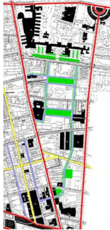
Fig.15.-B. Esquema de alternativa morfológica B. Apertura de la vía central local, cuyo eje se encuentre a 95-125 m aprox. al poniente del eje de Avda. La Paz, y sistemas complementarios según la figura adjunta. Dos parques centrales de barrio, están paralelos están al servicio de nuevas áreas residenciales más densas. Dos plazoletas para juego de infantes se disponen en manzanas menores.
