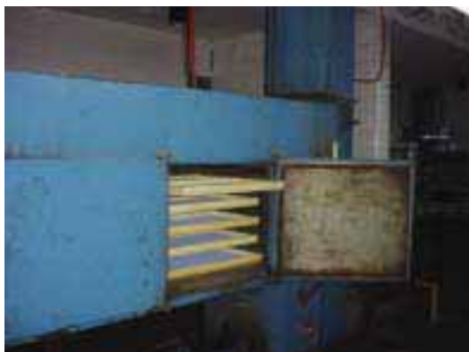
Lámina 26 Túnel deshidratador de aire forzado para elaborar láminas de pulpa de tuna Chile, 2004.
