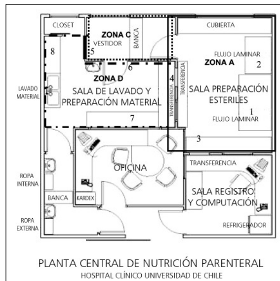
Figura 1. Plano de unidad de preparados estériles en el cual se indican los puntos de muestreo.
