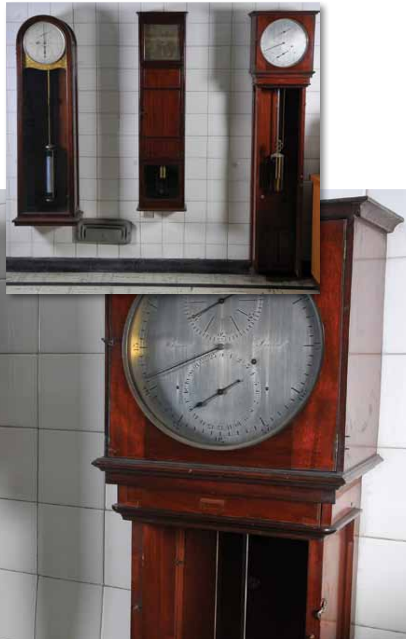
5. Tres relojes fijos permitían controlar los desfases horarios, dato fundamental para los cálculos astronómicos. El del centro data de 1856, el segundo -de 1912- es un reloj al vacío, y el tercero de 1908. Todos son "Riefler", la más famosa de las casas fabricantes de relojes astronómicos de alta precisión. Colección de instrumentos antiguos, OAN.
