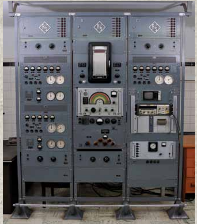
6. Reloj alemán de cuarzo, se consiguió para el observatorio después de la segunda guerra mundial, por el embajador de Chile en Berlín. Usa una radio y una televisión para corroborar la hora. El cuarzo oscila y por tanto "envejece", perdiendo precisión. Colección de instrumentos antiguos, OAN.
