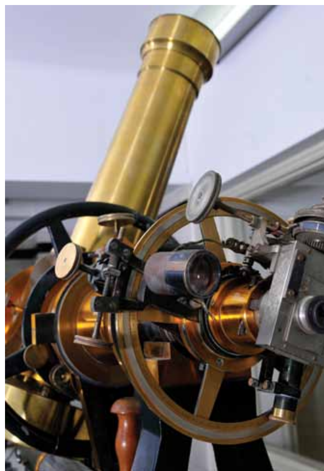
2. Círculo Meridiano Repsold. Los círculos meridianos se utilizan para observar el tránsito de un objeto astronómico a través del meridiano del observador. Este es un modelo antiguo, de las múltiples versiones del mismo que aparecieron desde fines del siglo XVIII. Construido en la década de 1930. Se utilizó para mantener constante la hora oficial de Chile. Colección de instrumentos antiguos, Observatorio Astronómico Nacional (OAN).
