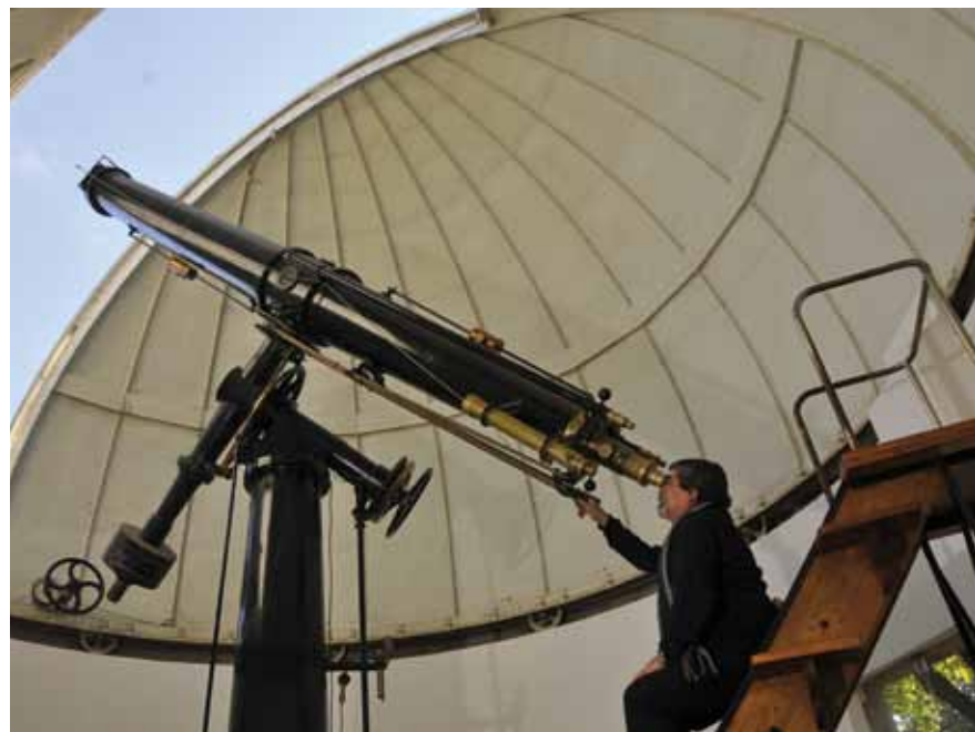
4. Telescopio refractor Heyde, objetivo de 28 centímetros de diámetro y 4,6 metros de distancia focal. El telescopio refractor Heyde, o antejo ecuatorial, fue traído desde Alemania en 1912 por Federico Guillermo Ristenpart, quien fue contratado por el presidente Pedro Montt para modernizar el observatorio. Fue instalado en Lo Espejo en junio de 1913 para observar unos 200 objetos nebulosos del cielo austral y luego estrellas dobles. Desde 1922 se utilizó para la observación de estrellas variables, cometas y pequeños planetas, entre ellos el Encke, el cometa de menor periodo de órbita en torno al sol (3,3 años). A partir de 1962 se destinó principalmente a la docencia y visitas guiadas del observatorio. Todas sus piezas son originales y funciona manualmente. No se tiene conocimiento de otro, en el mundo, que esté en operaciones. OAN.
