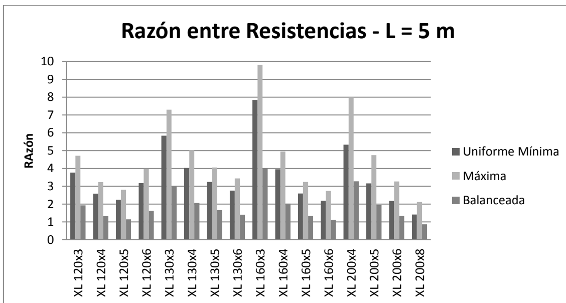
Figura 91: Razón entre resistencias para los perfiles de 5 m, AISC.
