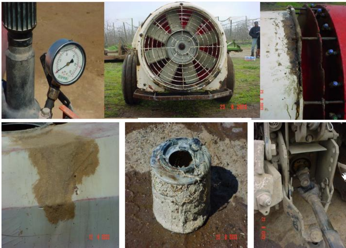
Ilustración 25: Equipos y componentes del pulverizador en malas condiciones
