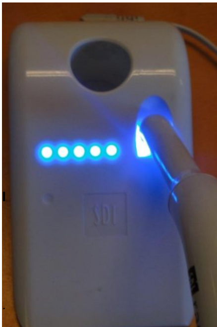
Imagen N°4: Radiómetro incorporado en la base de la lámpara. Las 5 luces encendidas indican el funcionamiento óptimo de la lámpara.
