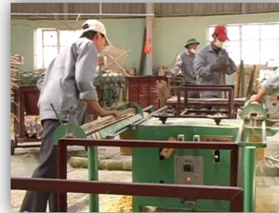
Corte del bambú en distintas secciones transversales por medio de sierra eléctrica
