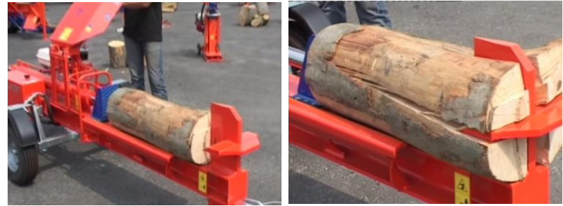
Fig. 19 - Las cortadoras de leñas permiten seccionar longitudinalmente el tronco por medio de una fuerza de empuje hacia los cuchillos.
