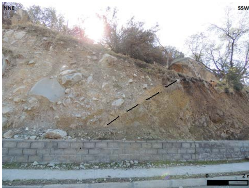
Figura 4.26. Depósito heterogéneo de bloques angulosos, se observa el contacto con la unidad de roca.
